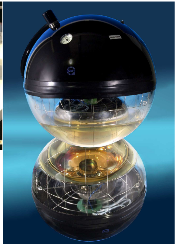
Fig. 7 – Photos d'un module optique. A l'intérieur de la sphère se trouve le photomultiplicateur.
